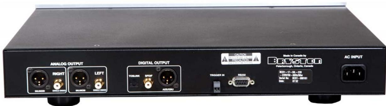
Uscite digitali toslink e AES/EBU, uscite analogiche anche bilanciate. Presente anche la presa RS232 per upgrade futuri.
