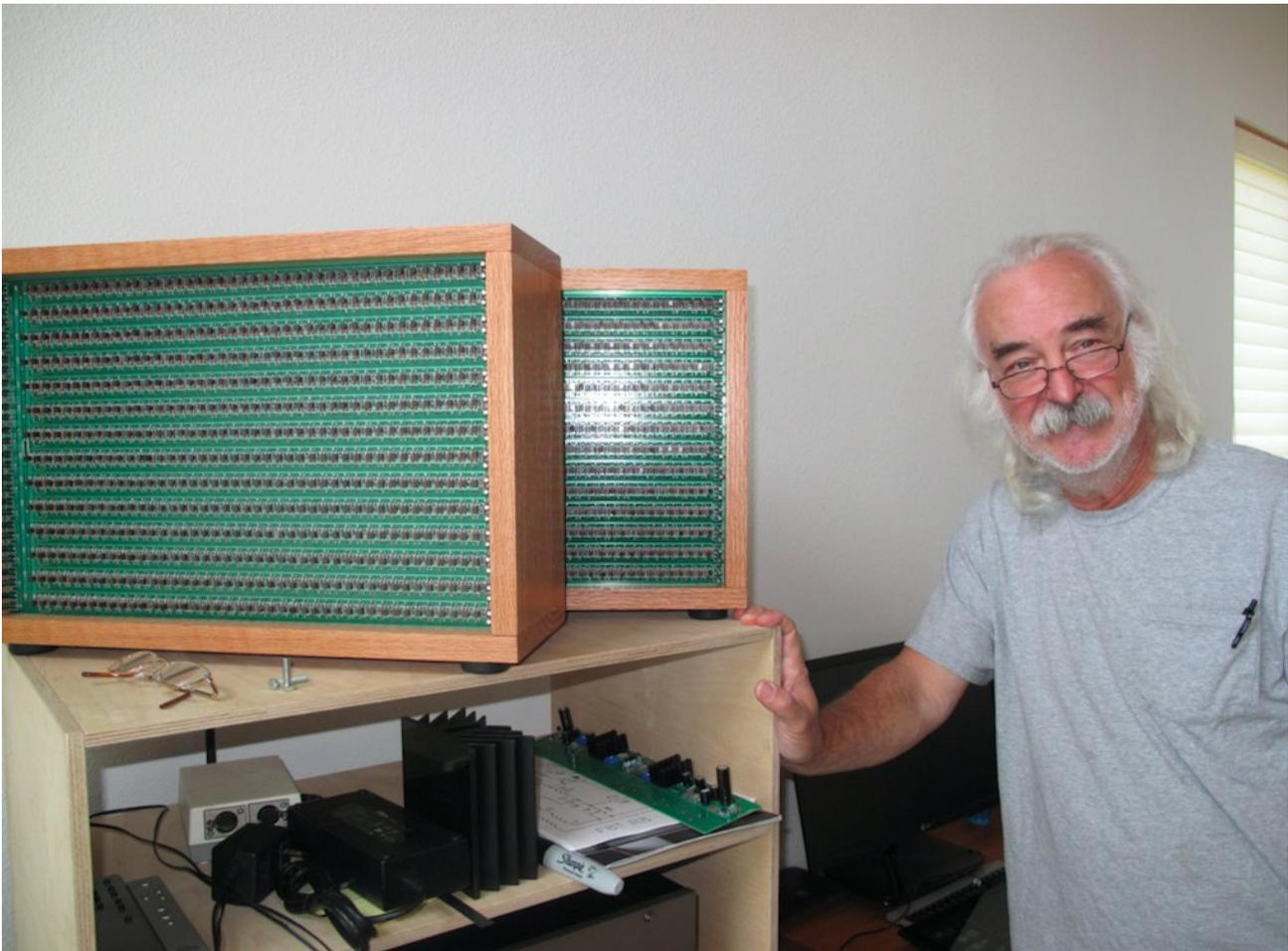
Per darvi un'idea di quanto sia creativa questa persona, prendete ad esempio "The Beast With a Thousand JFETs" (La Bestia dai Mille JFET), un singolo esemplare di amplificatore che Pass ha "dovuto" costruire. Nelson ha utilizzato uno "small-signal" JFET della Toshiba particolarmente ben suonante nello stadio di ingresso, e ha desiderato che i transistor in uscita
