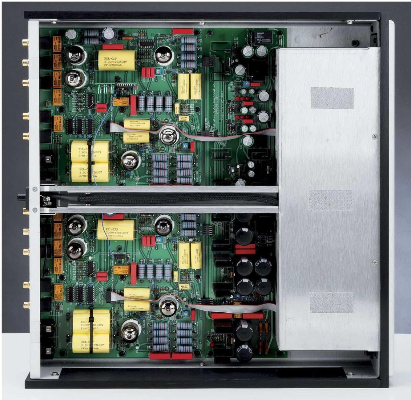
La sezione di alimentazione è posizionata dietro al frontale, racchiusa dentro una schermatura in lamiera; la circuizione è dual mono, le schede dei due canali sono separate; di ottima qualità la componentistica: resistenze Roederstein e condensatori RelCap all'1%. Le valvole di serie sono Sovtek.
