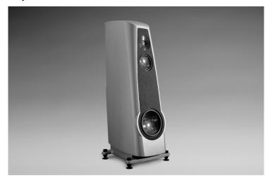
Diffusore da pavimento, woofer in fibra di carbonio multistrato da 10", midrange in fibra di carbonio multistrato da 6", tweeter con cupola in berillio da 1".
