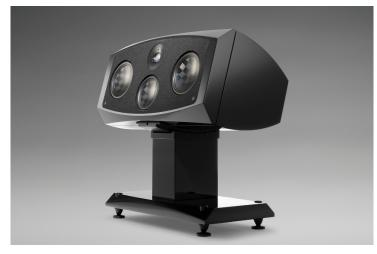
Diffusore per canale centrale, due woofer in fibra di carbonio multistrato da 7,25", midrange in fibra di carbonio multistrato da 6", tweeter con cupola in berillio da 1". Risposta in frequenza 45 Hz - 30 kHz @ -3dB, impedenza nominale 4 ohm, sensibilità 89 dB SPL/2,83 V, amplificazione minima raccomandata 30 watt. Peso 63,5 kg.
