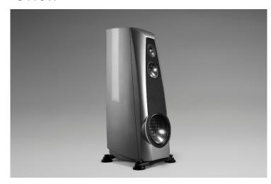
Diffusore da pavimento, woofer in fibra di carbonio multistrato da 13", midrange in fibra di carbonio multistrato da 7", tweeter con cupola in berillio da 1,25". Risposta in frequenza 20 Hz - 30 kHz @ -3dB, impedenza nominale 4 ohm, sensibilità 90 dB SPL/2,83 V, amplificazione minima raccomandata 50 watt. Peso 163 kg ciascun diffusore.
