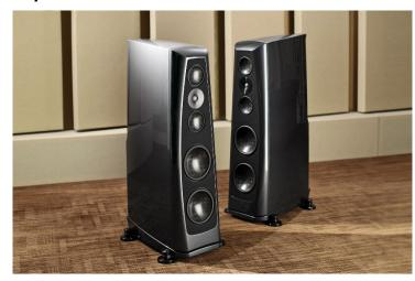
Diffusore da pavimento, due woofer in fibra di carbonio multistrato da 10", due midrange in fibra di carbonio multistrato da 6", tweeter con cupola in berillio da 1". Risposta in frequenza 20 Hz - 30 kHz @ -3dB, impedenza nominale 4 ohm, sensibilità 90 dB SPL/2,83 V, amplificazione minima raccomandata 30 watt. Peso 254 kg ciascun diffusore. Dimensioni LxAxP in mm: 358 x 1359 x 673 (ingombro con base).
