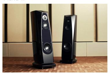
Diffusore da pavimento, woofer in fibra di carbonio multistrato da 9", midrange in fibra di carbonio multistrato da 6", tweeter con cupola in berillio da 1". Risposta in frequenza 28 Hz - 30 kHz @ -3dB, impedenza nominale 4 ohm, sensibilità 87,5 dB SPL/2,83 V, amplificazione minima raccomandata 50 watt. Peso 68 kg ciascun diffusore.
